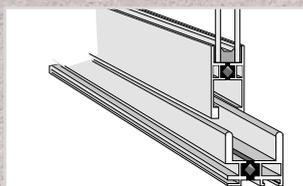
RUPTURE DE PONTS THERMIQUES : un matériau isolé sépare la partie extérieure de la partie intérieure afin d'éviter la condensation et toute déperdition de chaleur.
